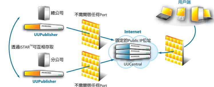
除了兩層交換架構效益外，透過UUCentral亦可提供遠端使用者連結多個Site內的應用伺服器，並且這多個Site也可透過UUCentral進行Site-to-Site的"SSL" VPN連結
